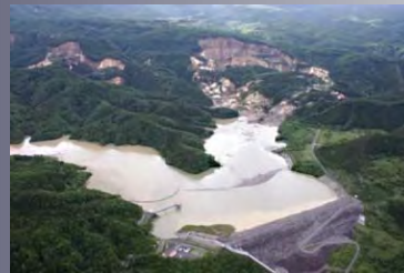
荒砥沢ダム近傍の大規模な斜面崩壊 (2008年岩手宮城内陸地震)
