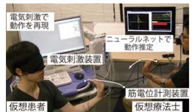
筋電位と電気刺激を利用した ヒト-ヒト関節運動伝達インタフェース
